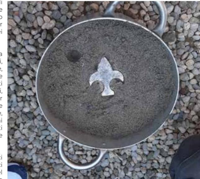
Giglio realizzato mediante fusione per dimostrazione agli alunni
